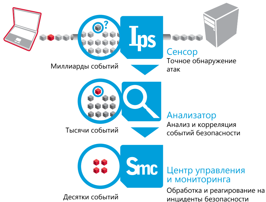
Рисунок. Принцип работы StoneGate IPS
